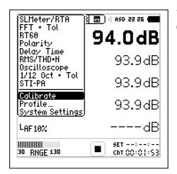
Am XL2 die Funktion (links) Calibrate oder das Profile (unten) Calibrate 94dB auswählen. Die Funktion Calibrate
